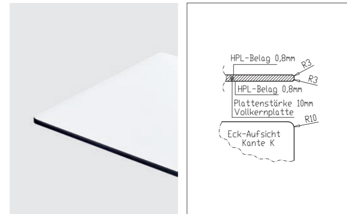
Kante K Tischplatte 10 mm stark, Vollkernplatte Radius oben und unten 3 mm
